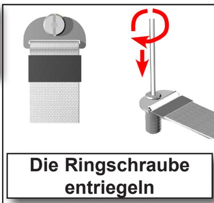
Der Gurt muss gespannt sein und die Umlaufplatte muss die Unterseite des Gurtdurchgangs berühren
