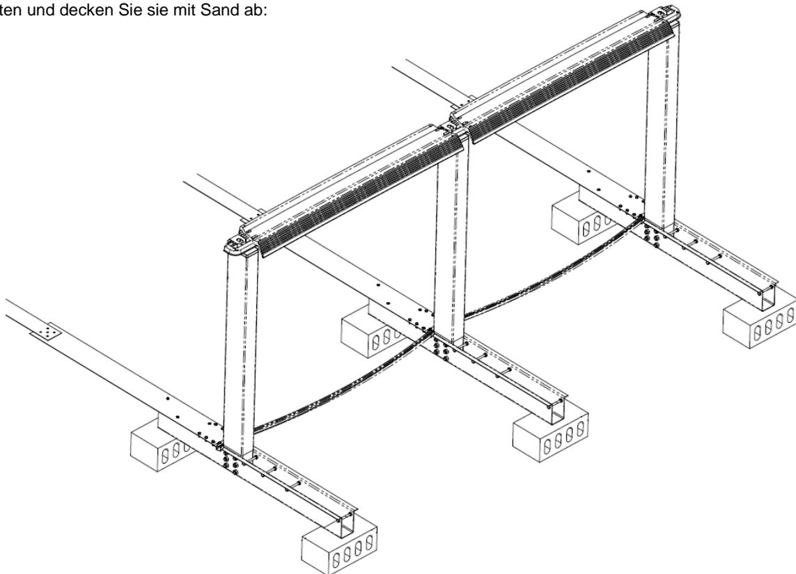
**Überprüfen Sie genau den Abstand zwischen allen Stützpfosten (Maß S im Kapitel 7.1) und deren senkrechte Ausrichtung. Es muss ebenfalls überprüft werden, dass es zwischen den einzelnen Pfosten keine Höhenunterschiede gibt.**
