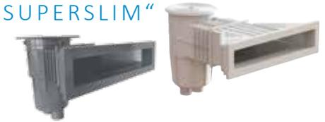
Oberflächenabsauger SLIM für Beton- und Folienbecken. Material ABS, mit Deckel und Überlauf D40, Saugplatte und Blende, Messingbüchsen; Anschluss: 1 1/2" I.G. Filter, 2" I.G. Ablauf; Ansaugbreite: 500 mm; Ansaughöhe: 85 mm
