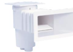
Oberflächenabsauger WH Plus für Beton- und Folienbecken. Material ABS, mit Deckel und Überlauf D32, Saugplatte und Blende, Anschluss: 1 1/2" I.G. Filter, 2" I.G. Ablauf; Ansaugbreite: 360 mm | Ansaughöhe: 160 mm
