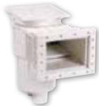
Oberflächenabsauger STD 2 für Beton- und Folienbecken. Material ABS, mit Deckel und Überlauf D32, Höhenausgleich 35 mm, Saugplatte und Blende, Messingbüchsen; Anschluss: 1 1/2" I.G. Filter, 2" I.G. Ablauf; Ansaugbreite: 209 mm | Ansaughöhe: 144 mm
