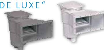
Oberflächenabsauger WH DE LUXE für Beton- und Folienbecken. Material ABS, mit Deckel und Überlauf D32, Höhenausgleich 35 mm, Saugplatte und Blende, Messingbüchsen; Anschluss: 1 1/2" I.G. Filter, 2" I.G. Ablauf; Ansaugbreite: 372 mm, Ansaughöhe: 155 mm
