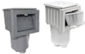
Nur 25 cm Tiefe, speziell geeignet für den Einbau in Styroporbausteine. Für Beton- und Folienbecken. Material ABS, mit Deckel und Überlauf D32, Höhenausgleich 35 mm, Blende, Messingbüchsen; Anschluss: 2" I.G. / DA63 Klebe; Ansaugbreite: 209 mm | Ansaughöhe: 144 mm; Einbautiefe: 25 cm
